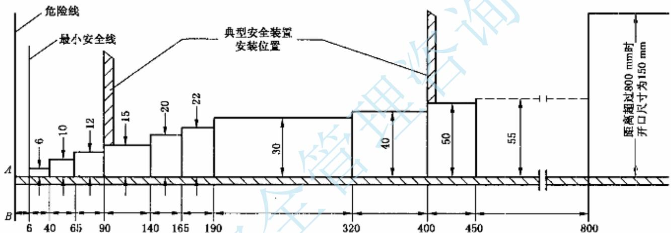
图 2 防护罩或防护隔栏的安装位置
