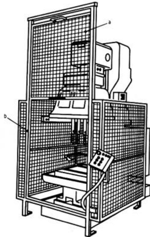
图 8 使用带防护锁定的联锁防护装置和固定式防护装置的钻床安全防护示例
