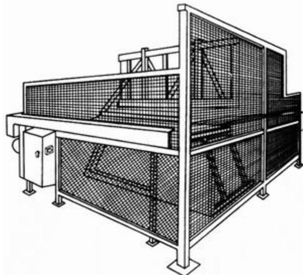
图 2 距离防护装置示例
