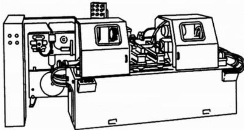
图 7 滑动型联锁防护装置示例
