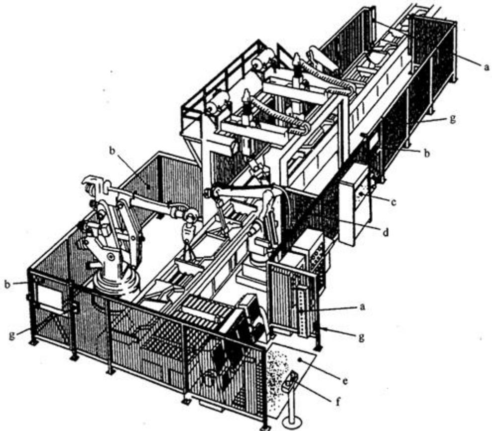
图9 不同类型的防护装置的组合及防护装置与其他保护装置组合示例 1
