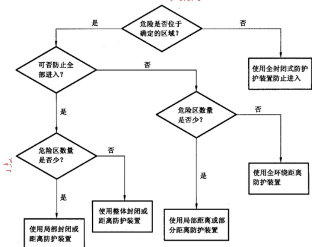
图 C.1 根据危险的数量和位置选择防护装置
