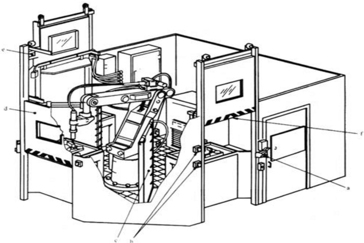
图 10 不同类型的防护装置的组合及防护装置与其他保护装置组合示例 2
