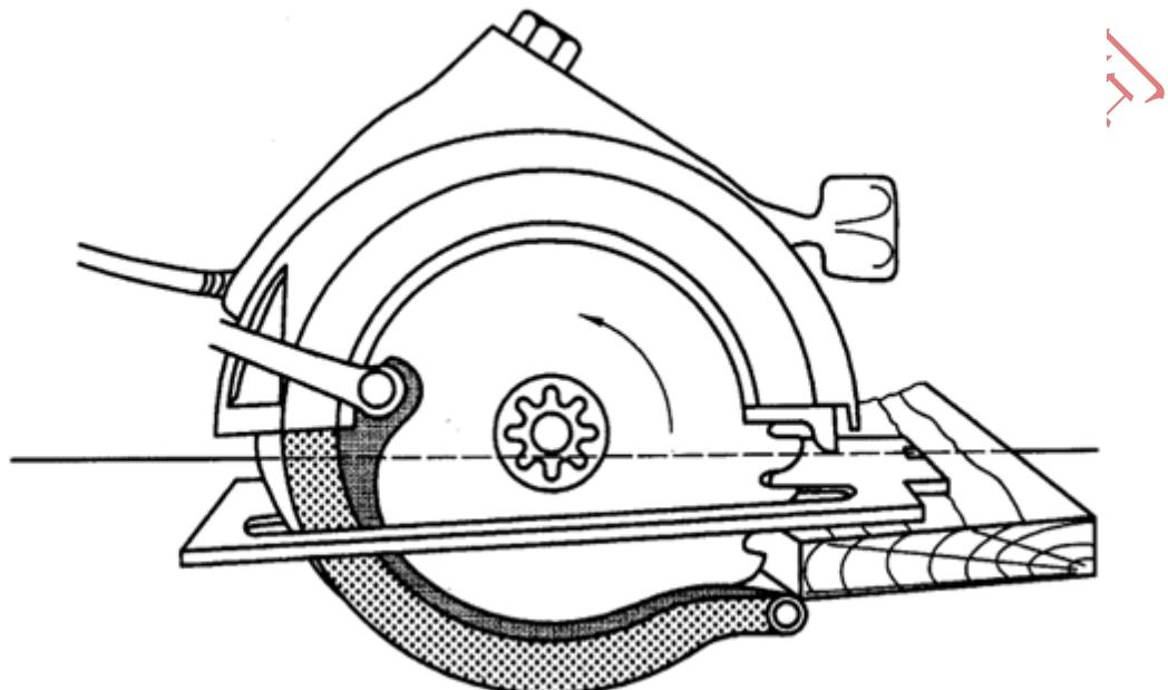
图 4 自关闭式防护装置示例
